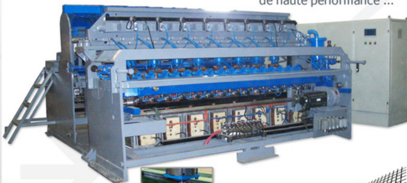
GTCHE-12 Système d'étréage du fil métallique avec système « dancer » (pantin de régulation de dévidage)...
